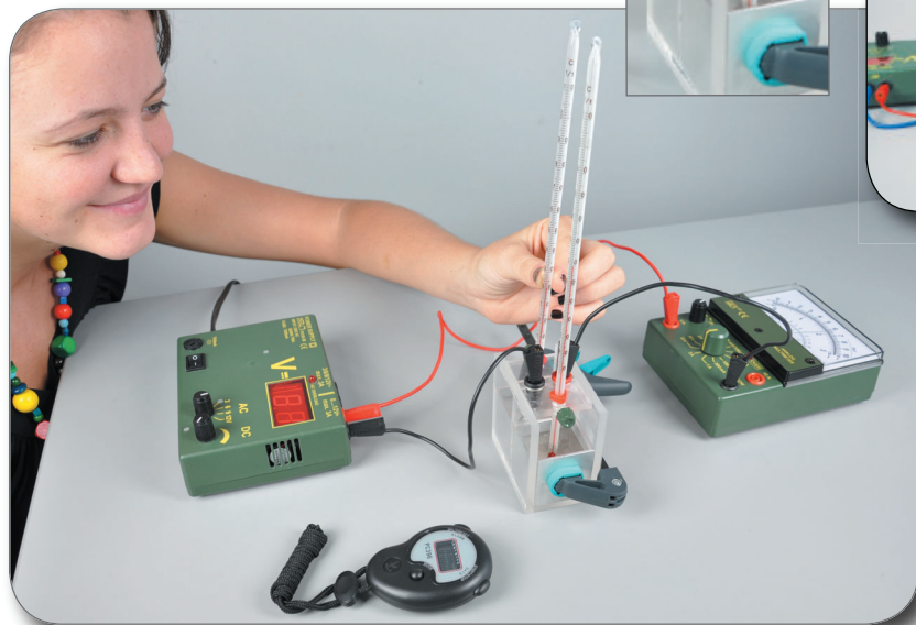
TDS 5.2 Termoelektrické chlazení „Peltierův efekt“
