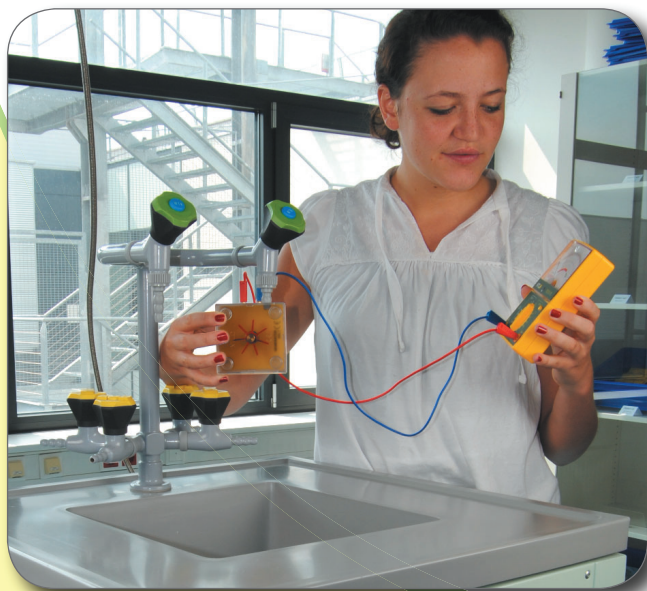
Přeměna vodní energie na elektrickou energii
