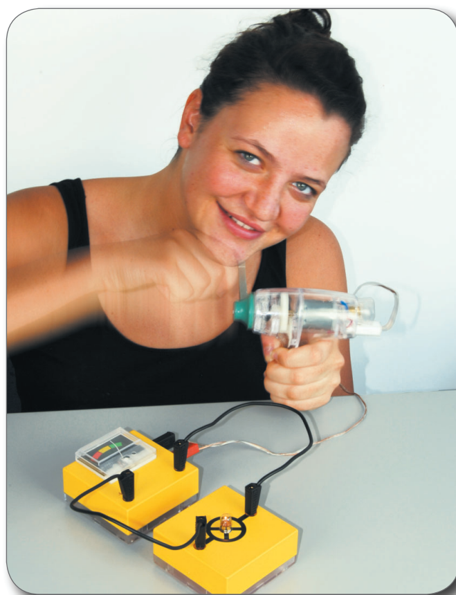
Zásobník energie s ukazatelem (princip hybridního pohonu)
