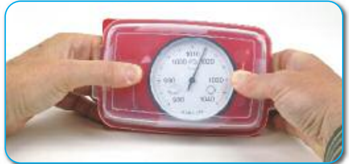
Pokus: Demonstrace "výšky tlaku" s barometrickou jednotkou
