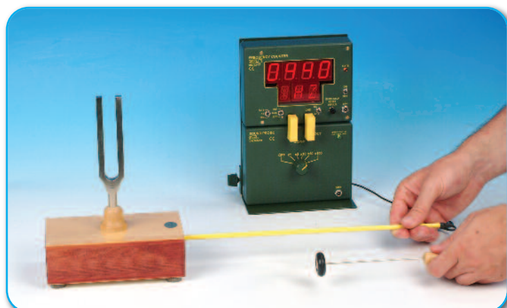
Pokus: měření frekvence ladičky
