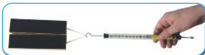
Detail: Zdvojnásobení třecí plochy rozložením tělesa
