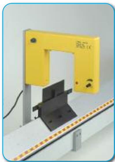
Detail: Upevnění držáku optické závory na vzduchové dráze
