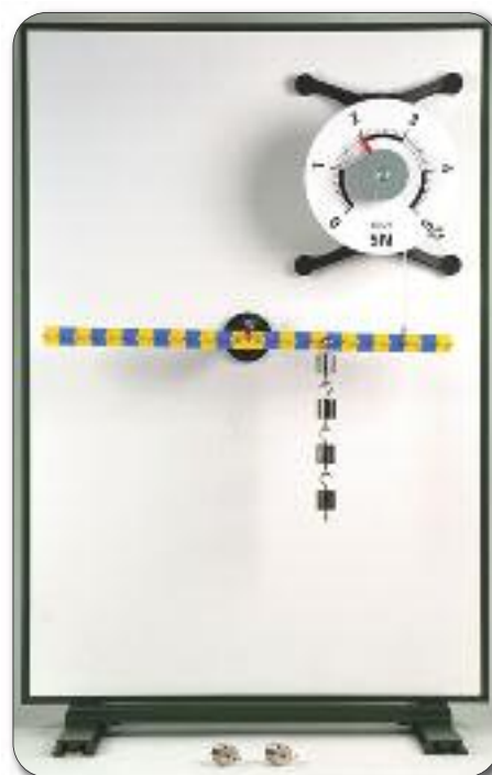
Pokus: Jednoramenná páka na magnetické tabuli
