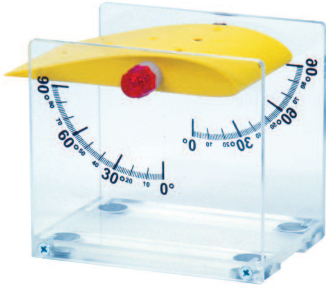
Pokus: Měření vztlaku na křídle
