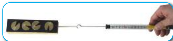
Detail: Zdvojnásobení hmotnosti tělesa přiložením závaží s výřezem
