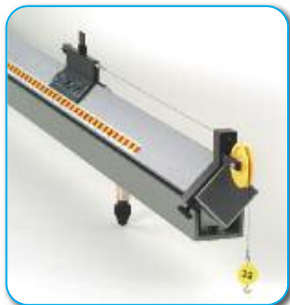
Detail: Závaží (hnací těleso v dynamice) na šňůrce vedené přes vodicí kladku
