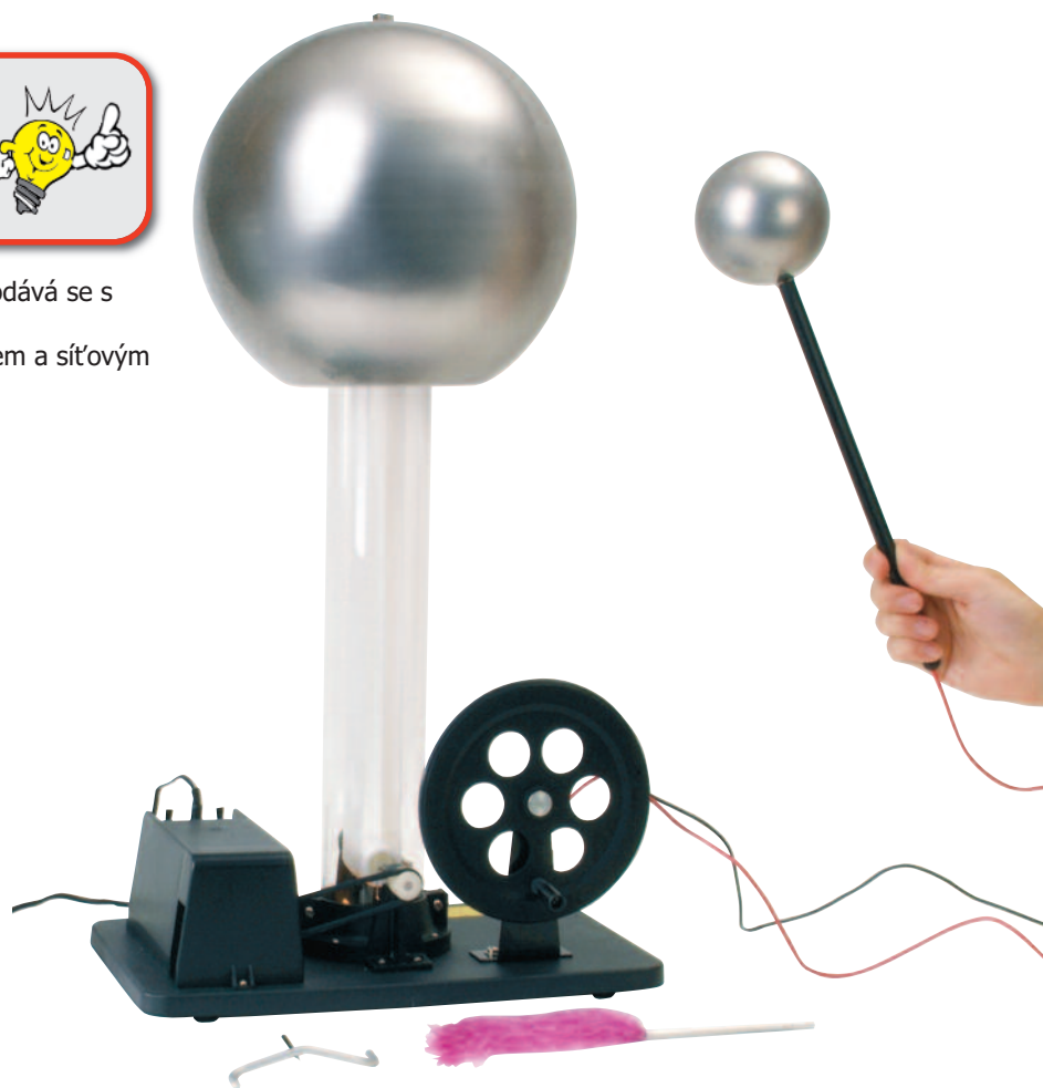
Pokus : Nabíjení lidského těla přes Van de Graaffův generátor
