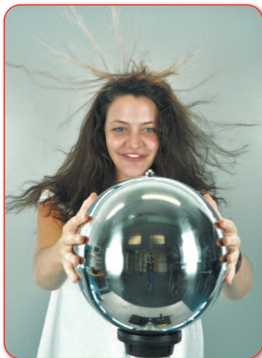
Pokus : Nabíjení lidského těla přes Van de Graaffův generátor
