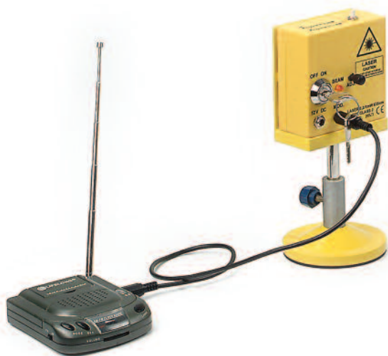
Pokus: Modulace laserového světla
