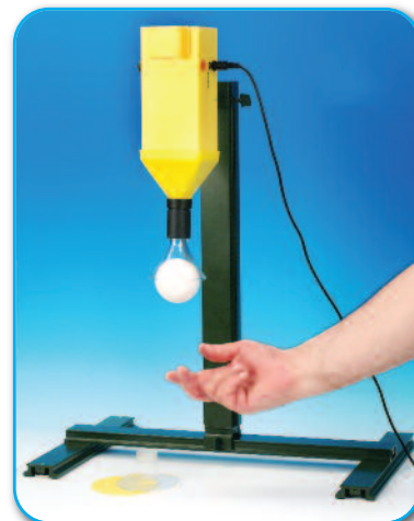
Pokus: Aerodynamický paradox
